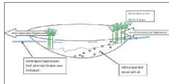
Bei einem Regenereignis fließt das leicht verschmutzte Regenwasser über den Regenwasserkanal ins Regenrückhaltebecken. Durch das Herabsetzen der Fließgeschwindigkeit setzen sich die Schmutzpartikel am Grund des Beckens ab. Nährstoffe werden in der Belebten Bodenschicht von den Pflanzen aufgenommen. Das so gereinigte Regenwasser verlässt das Regenklärbecken am Überlauf und fließt dann durch den Graben in den Krebsbach.
