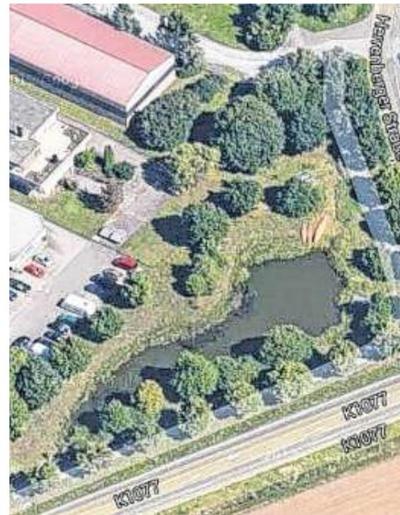
Im Letten findet sich ein Beispiel für ein Regenrückhaltebecken mit belebter Bodenschicht im Trennsystem
